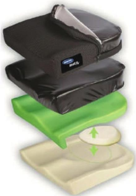
Invacare Matrix VI è progettato per garantire comfort e stabilità del bacino grazie ad una nuova combinazione di materiali: una base inferiore semi rigida, studiata per fornire sostegno, un disco in visco elastico che distribuisce i punti di pressione, e una superficie sagomata superiore in foam leggero con Ultra Fresh™.
