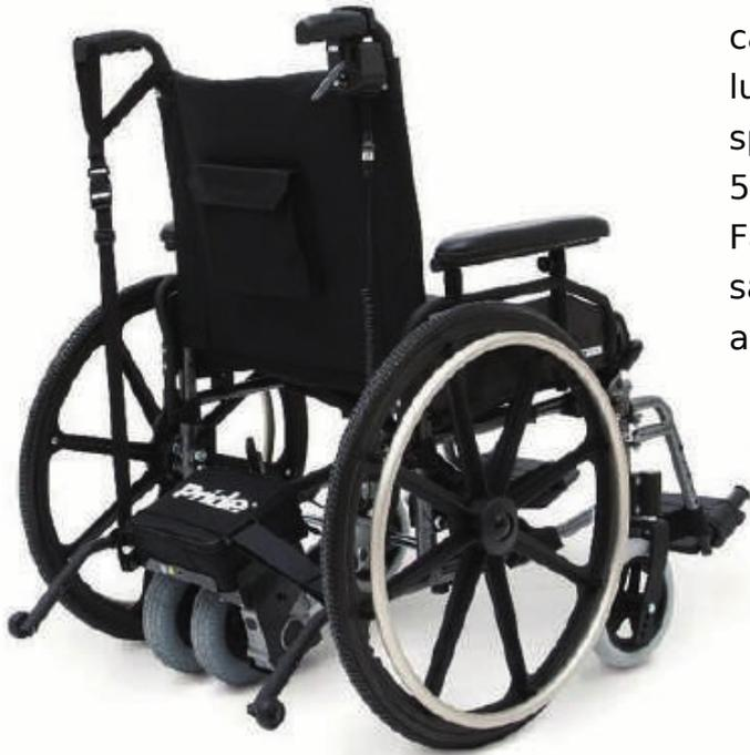
Il Power Glide è un sistema di spinta assistita che può essere applicato alle carrozzine manuali. La guida della carrozzina da parte di un assistente è facilitata su lunghe percorrenze o su terreni poco agevoli alla spinta. Il Power Glide ha una velocità massima di 5,5 Km/h ed un'autonomia di circa 15 km. Facilissimo da montare e da utilizzare, il Power Glide sarà sempre con voi grazie al suo design compatto e al peso contenuto.
