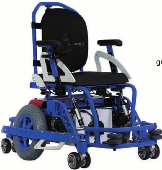
Xtreme è una carrozzina elettronica leggera, maneggevole ed estremamente potente, sviluppata per massimizzare le abilità dell'atleta in carrozzina. Le ruote campanate ed il baricentro molto basso le conferiscono stabilità ed estrema manovrabilità, conferendole un'anima sportiva e una precisione di guida eccezionale.
