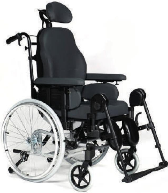
La Breezy Relax<sup>2</sup> è una carrozzina basculante per il posizionamento dell'utente resistente, confortevole e dal look moderno. Offre altezza e profondità della seduta, altezza dello schienale e lunghezza dei braccioli regolabili e la possibilità di regolare con continuità la reclinazione dello schienale e il basculamento della seduta. La Relax<sup>2</sup> può essere personalizzata in base alle vostre necessità per assicurarvi sempre il massimo comfort.
