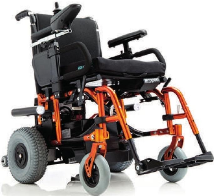
Variotronic è un modello speciale a doppio uso. Può essere utilizzata in versione manuale come carrozzina superleggera (Exelle Vario) oppure in versione elettronica (Variotronic) innestando un apposito kit, di facile e veloce montaggio, che garantisce al prodotto potenza ed affidabilità nell'uso esterno.
