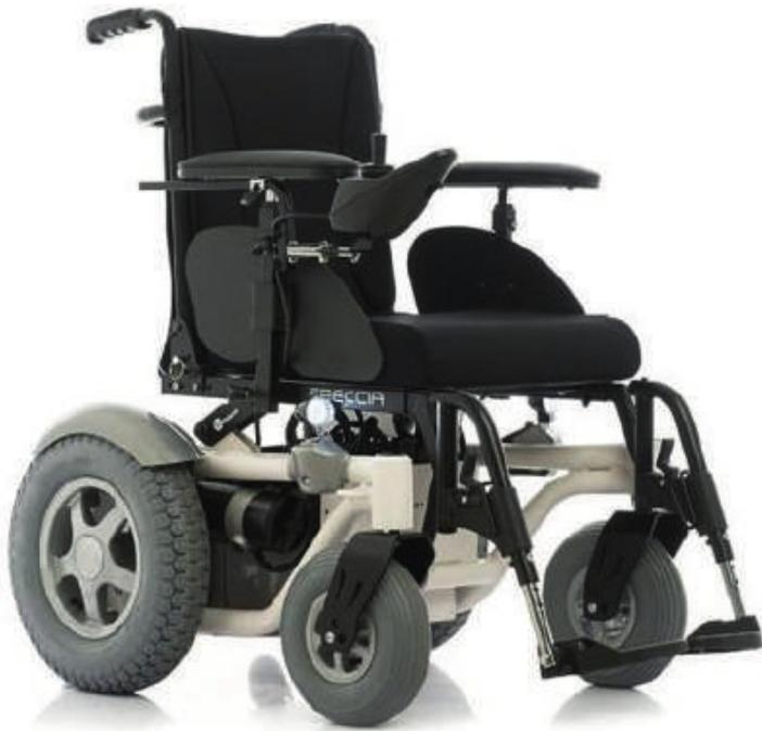
Carrozzina elettrica a telaio fisso da esterni dotata di basculamento elettronico. Studiata per coloro che hanno una ridotta capacità motoria ma in grado di gestire elementi di guida elettronici per raggiungere il massimo grado di autonomia e indipendenza. Adattabile anatomicamente per conferire comfort e sicurezza al soggetto. Disponibile in diverse misure e colori. Provvista di ruote pneumatiche indicate per terreni particolarmente sconnessi.
