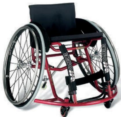
Carrozzina da basket realizzata su misura, in alluminio, consente la regolazione dell'asse delle ruote posteriori per trovare il giusto baricentro dell'atleta. Estremamente agile e sensibile ai cambi di direzione, è indicata per atleti che si affacciano al basket in carrozzina. Disponibile con ruote da 24", 25", 26" e 28". Assist 2 può essere richiesta con schienale abbattibile per un facile trasporto. Disponibile anche con ruote Spinegy.
