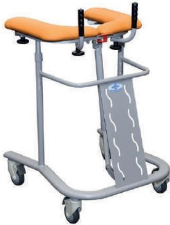
Deambulatore in acciaio verniciato con due maniglie regolabili e quattro ruote piroettanti con sistema di freno individuale. I piani di appoggio sono regolabili manualmente in larghezza e in altezza tramite un pistone a gas azionato da comando a leva. Questo sistema di regolazioni consente di adattare l'ausilio in modo semplice ed immediato alla corporatura della persona.
