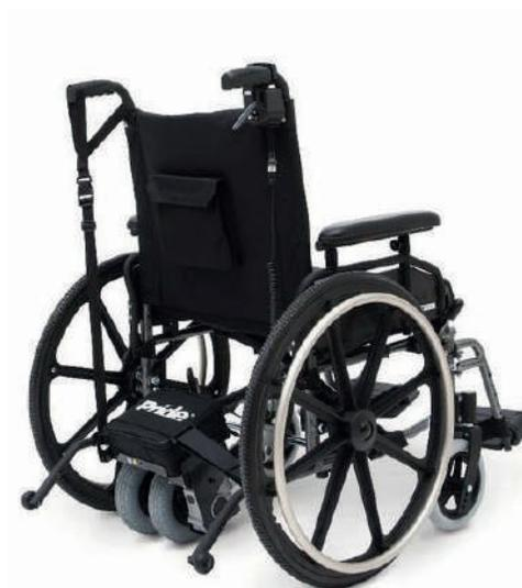
Il Power Glide è un sistema di spinta assistita che può essere applicato alle carrozzine manuali. La guida della carrozzina da parte di un assistente è facilitata su lunghe percorrenze o su terreni poco agevoli alla spinta. Il Power Glide ha una velocità massima di 5,5 Km/h ed un'autonomia di circa 15 km. Facilissimo da montare e da utilizzare, il Power Glide sarà sempre con voi grazie al suo design compatto e al peso contenuto.
